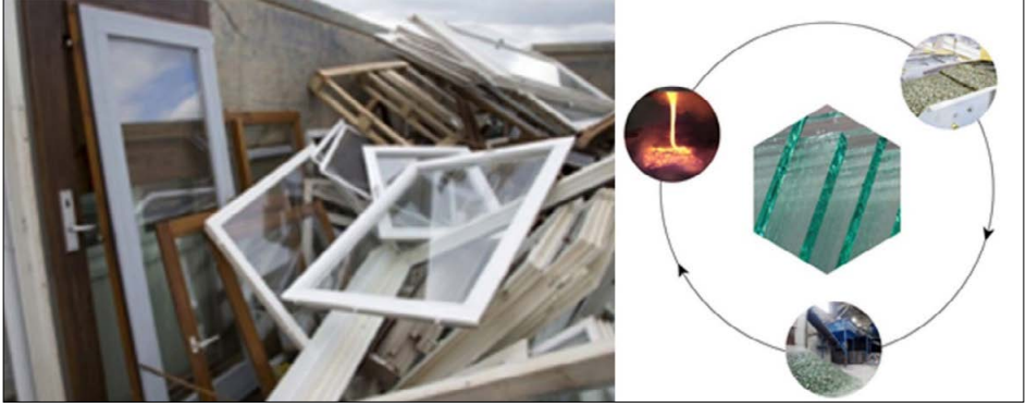
Şekil 80. Sol, geri dönüşüm için toplanmış cam öbekleri (Granger, 2018); sağ, camın geri dönüşüm süreci
