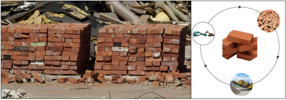
Şekil 81. Sol, enkazdan toplanan kil tuğlalar; sağ, tuğlanın geri dönüşüm süreci
