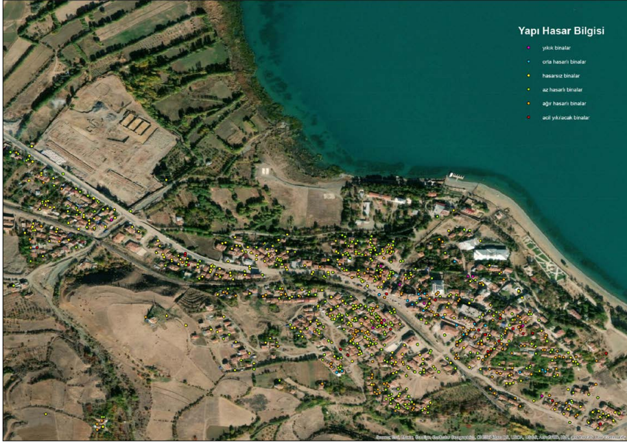
Şekil 62. Sivrice ilçesi, Gölbaşı mahallesi, hasar durumuna göre yapılar
